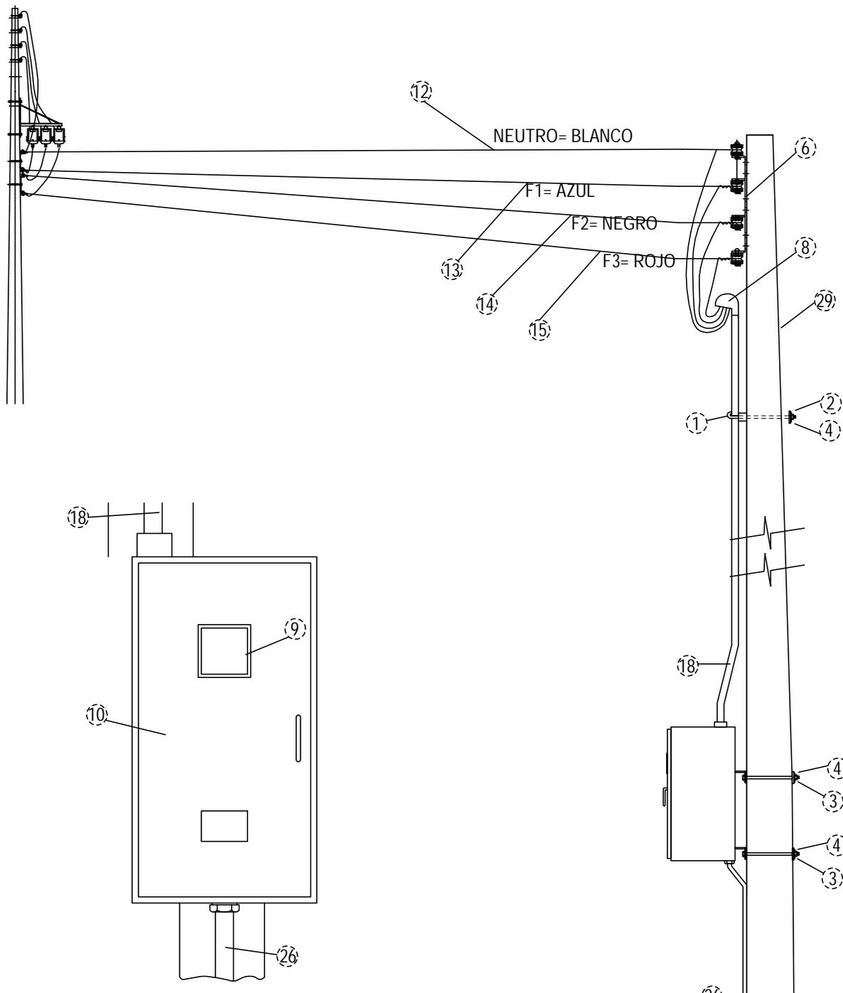
DETALLE MONTAJE CAJA DE EMPALME
